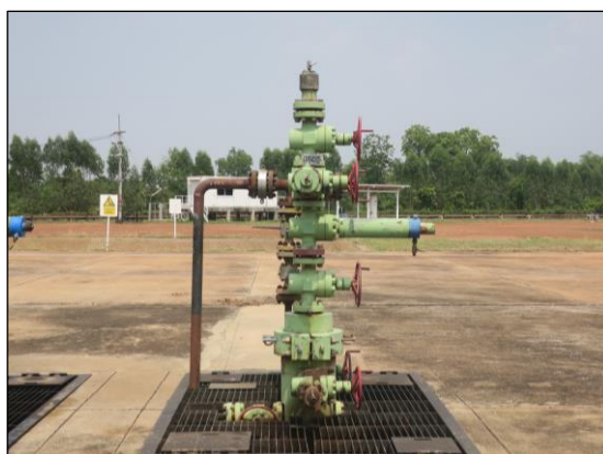
ชุดวาล์วหัวบ่อ (Christmas Tree) และบ่อเก็บน้ำบริเวณวาล์วหัวบ่อ (Well Cellar Pit)
